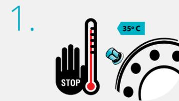
1. Lassen Sie die Räder unter 35° C abkühlen. Entfernen Sie die Mutterabdeckungen.
