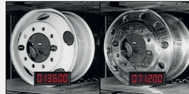
Die Räder werden in eine Presse gelegt und diese wird geschlossen, bis sich das Rad um 5 cm verformt:
